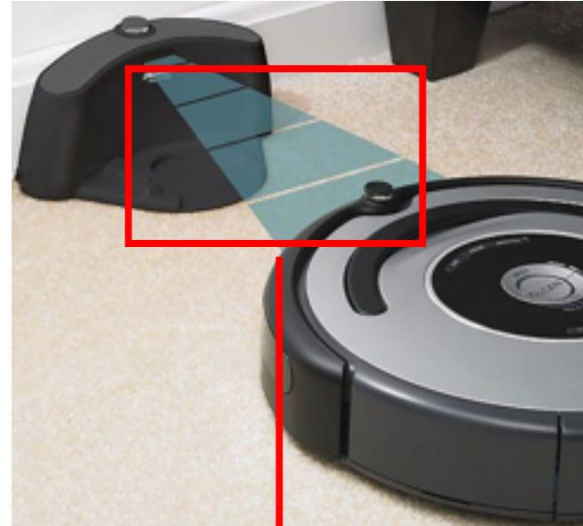
充电基座内集成无线充电发射端，机器人内集成无线充电接收端，机器人靠近基座时自动完成充电
