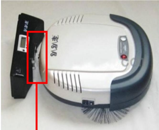
通金属触点连接电源
